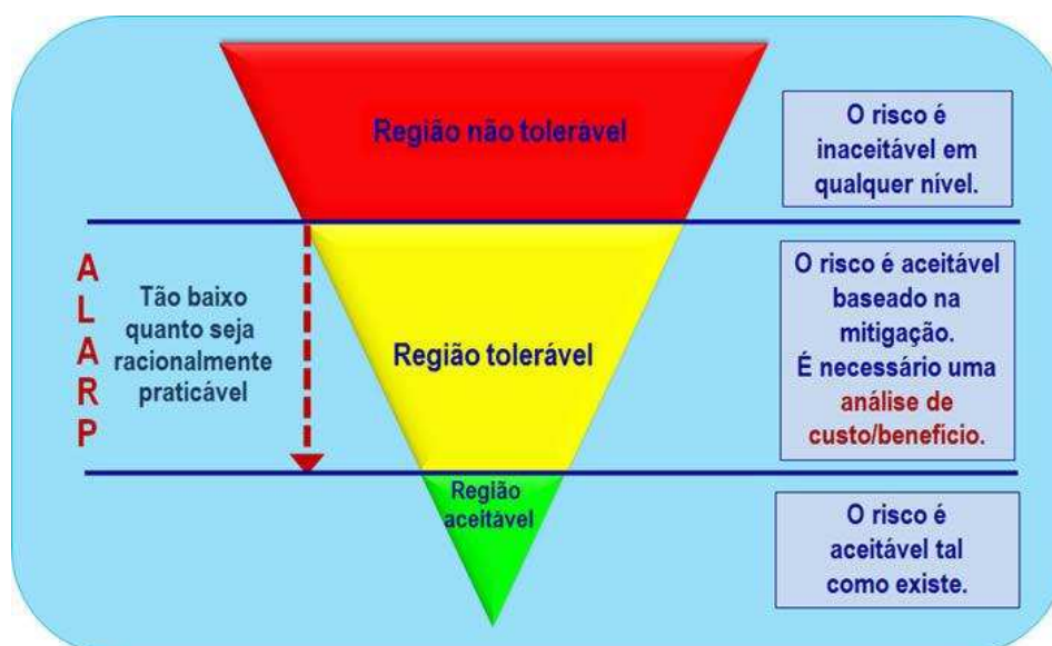
Figura 11 – Triângulo invertido das regiões de risco (Fonte: PILOTO POLICIAL, 2013).
