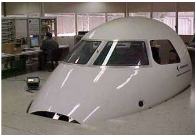
Figura 1 – Cabine do iron bird do Embraer 190 (Embraer)
