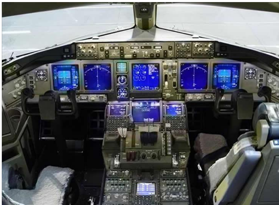
FIGURA 2 - Cabine de voo com Displays para integração de dados (Boeing 777). Fonte: Google Images (2011b).
