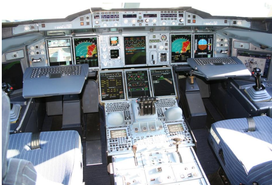
FIGURA 3 - Cabine de voo com Displays para integração de dados (Airbus A380). Fonte: Google Images (2011c).
